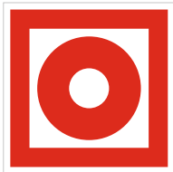
F 10 Кнопка включения установок (систем) пожарной автоматики
