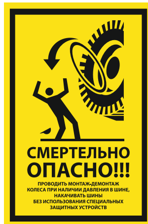
VS 21-06 Смертельно опасно! Проводить монтаж-демонтаж колеса при наличии давления в шине, накачивать шины без использования специальных защитных устройств
